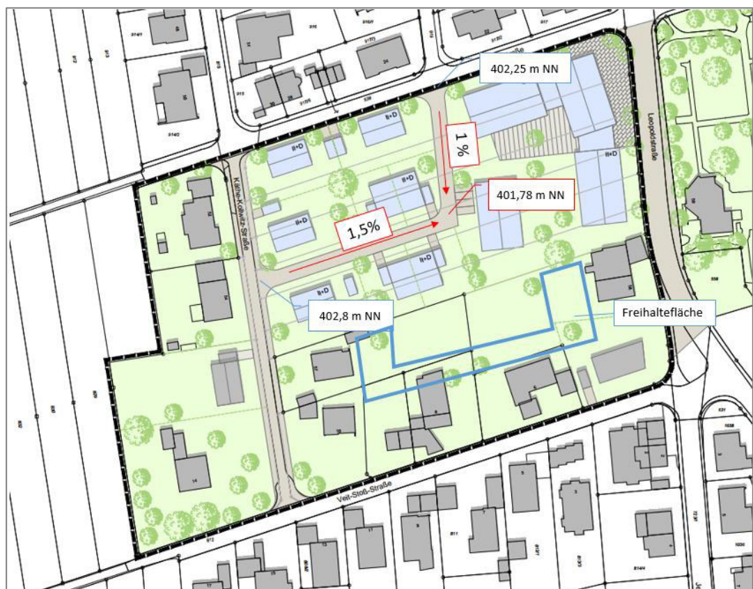
Abbildung 6: Höhenplanung Erschließungsstraße Variante 1a und b
