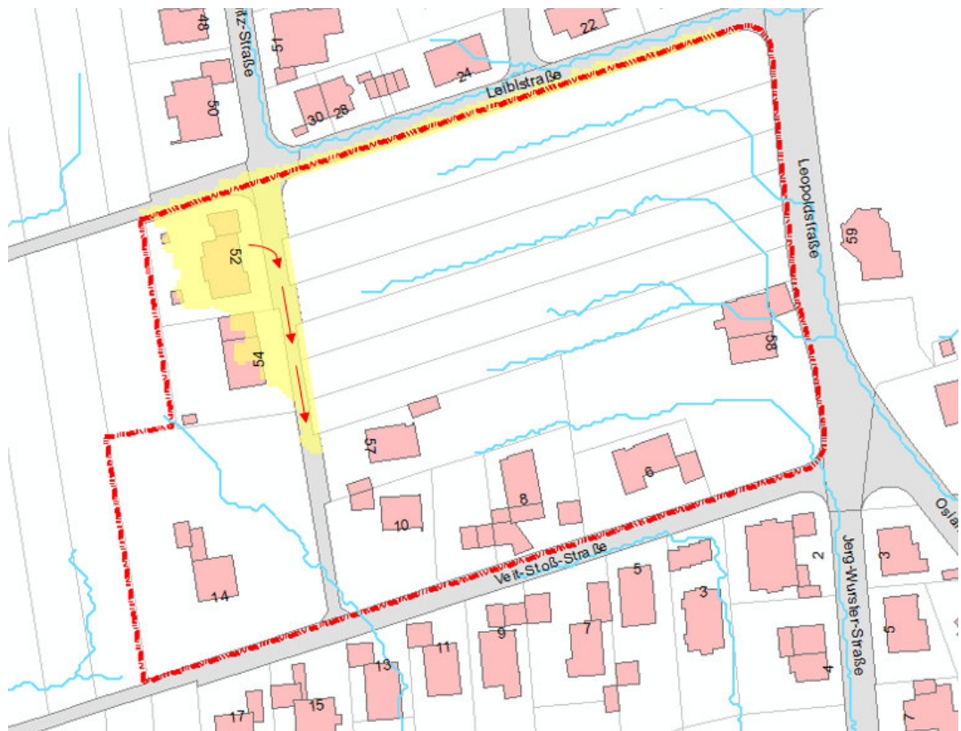
Abbildung 19: Ableitung des Außengebiets über die Käthe-Kollwitz-Straße
