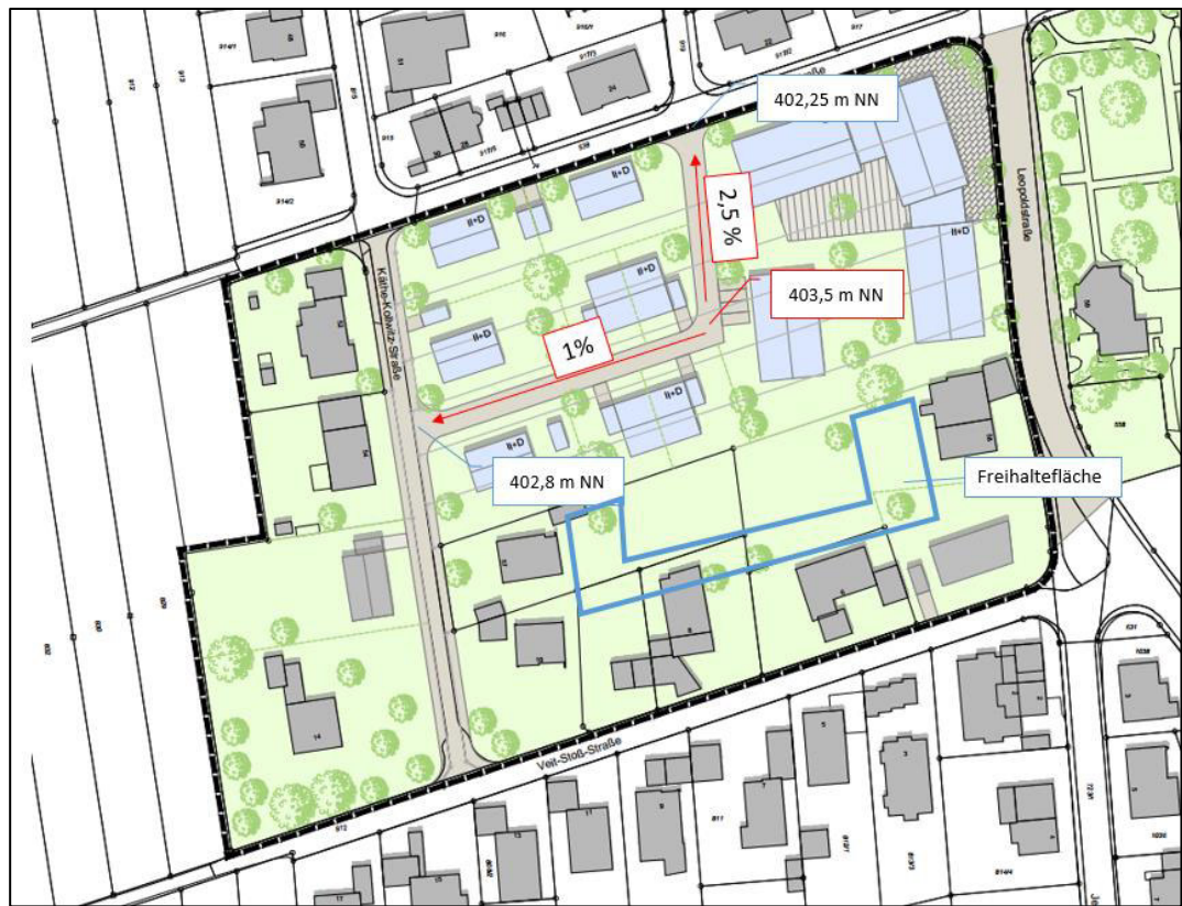
Abbildung 7: Höhenplanung Erschließungsstraße Variante 2a und b
