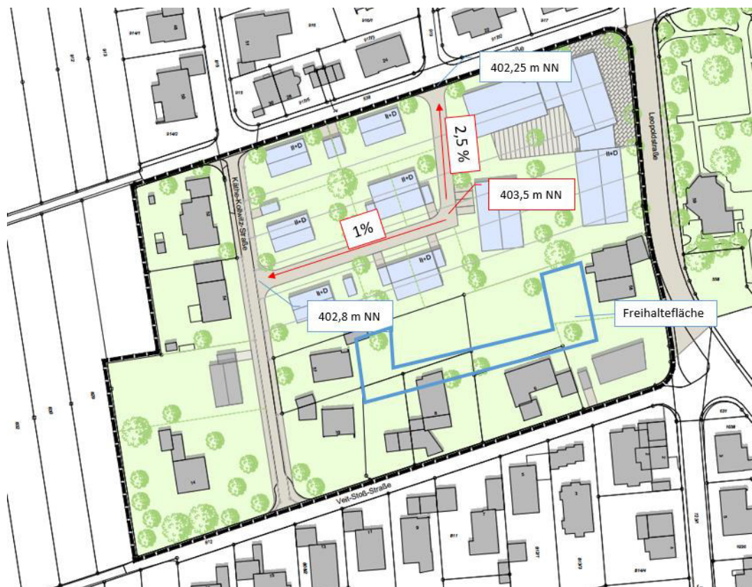
Abbildung 16: Höhenplanung Erschließungsstraße Variante 2a
