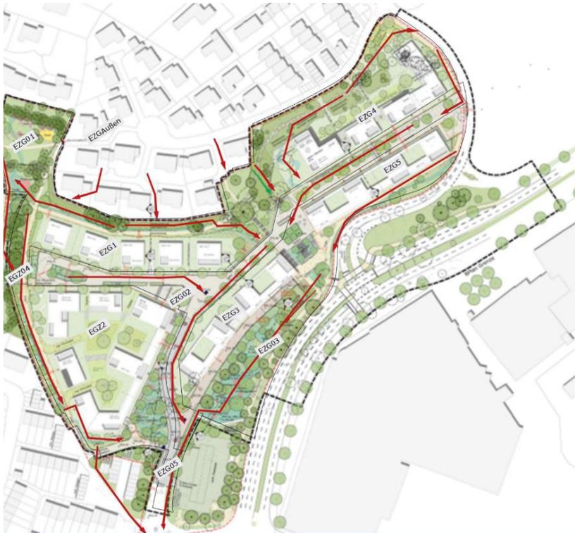
Abbildung 4: Notwasserwege (Kennzeichnung durch rote Pfeile)
