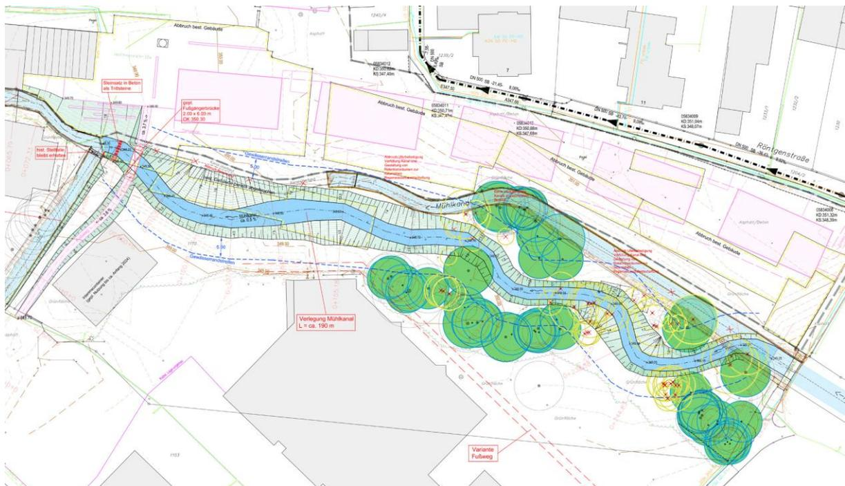
Abbildung 6: Mögliche Gestaltung des Mühlkanals. Die Verlegung erleichtert die Entwicklung zu einem strukturreichen Gewässers mit naturnahem Gewässerrandstreifen.
