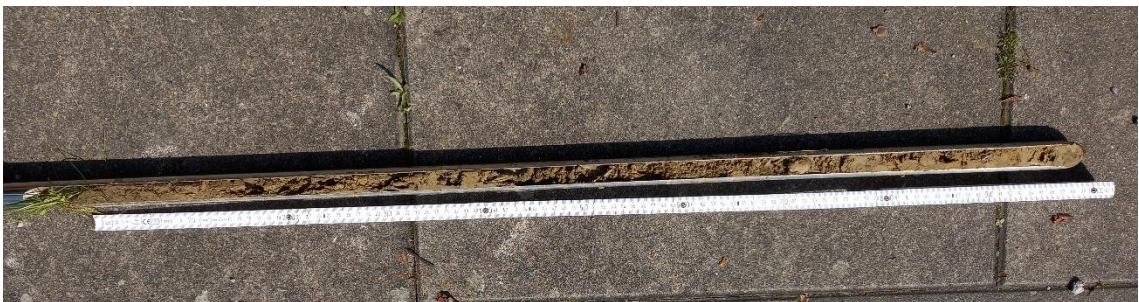
Abbildung 13: Bohrstockprofil 3 anthropogen veränderte Aufschüttung (Kolluvium).
