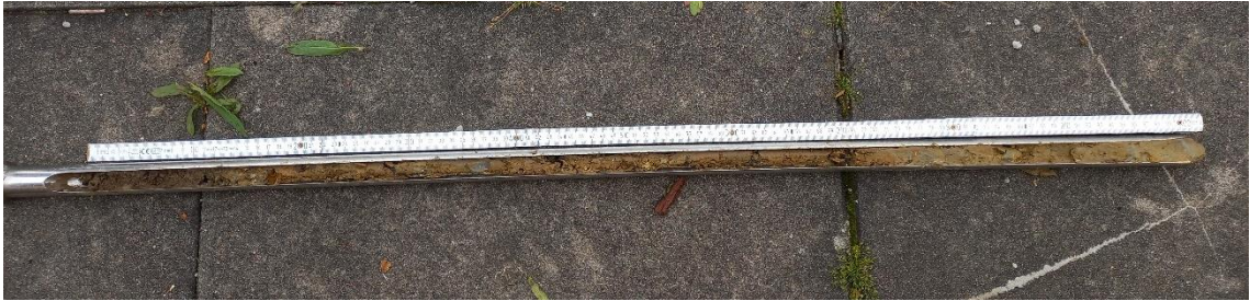
Abbildung 11: Bohrstockprofil 1 anthropogen veränderte Aufschüttung (Kolluvium).
