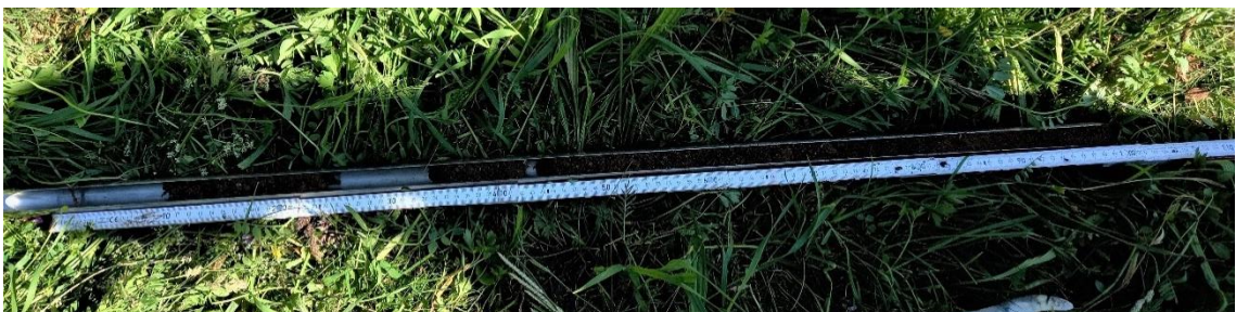
Abbildung 14: Bohrstockprofil 4 anthropogen veränderte Aufschüttung (Kolluvium).
